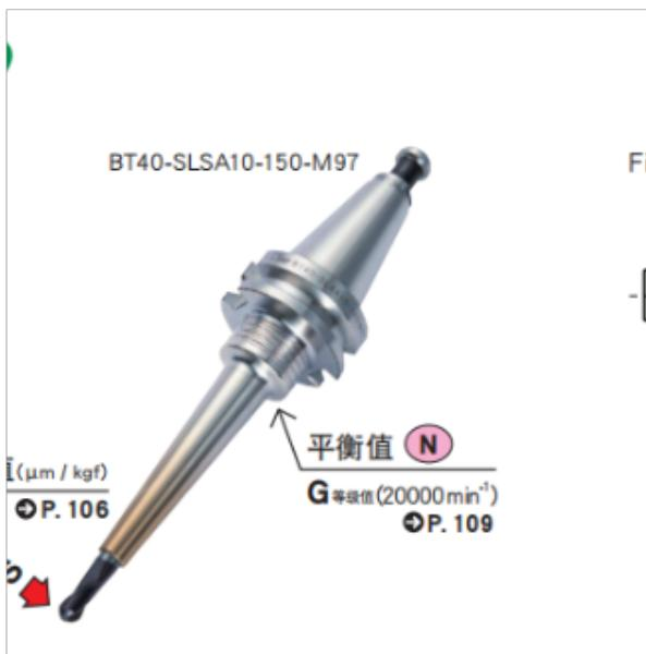
系统精度包括系统定位夹持精度和刀具重复定位精度，前者指刀具与刀柄、刀柄与机床上主轴的连接精度；后者指每次换刀后刀具系统精度的一致性。刀具系统具有较高的系统精度，才能保证高速加工条件下刀具系统应有的静态和动态稳定性。GER 高速刀柄GER 刀柄配用3um 级筒夹，跳动精度小于5um 刀柄夹装范围为整数，装夹柄径必须为6，不能装夹小数，而ER 弹性刀柄可以装夹范围5 ~ 6 内；由于刀柄装夹的筒夹变形量小，所以达到重复装夹精度高，筒夹的使用寿命长等特点。系统刚度：刀具系统的静、动刚度是影响加工精度及切削性能的重要因素。刀具系统刚度不足会导致刀具系统振动，从而降低加工精度，并加剧刀具的磨损，降低刀具的使用寿命。GER高速刀柄选用特殊材料，经过工艺处理，硬度在58-60° 之间，与主轴硬度接近，加强耐磨性，在常规热处理下，还增加了-196° 超深冷处理。锥度严格执行AT3 标准，贴合面达90% 以上。MST 刀具强力热装刀柄多少钱铣刀的种类很多，按齿背形式分铣刀可分为尖齿铣刀和铲齿铣刀两大类。
